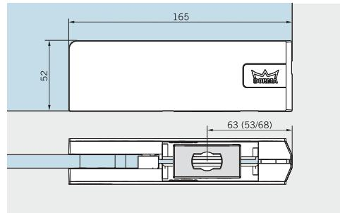
dormakaba Mundus PT 10 Comfort cam kapı alt menteşesi konik formda veya Ø 14 mm yuvarlak formda yuvaya sahiptir. Maksimum cam kanat ağırlığı 150 kg. Temperli camla kullanılır. dormakaba BTS 75, BTS 80, BTS 84, BTS 60 ile rahatlıkla kullanılır.
