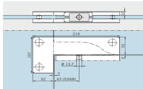
dormakaba Mundus PT 40 Comfort cam kapı L menteşesi, cam kapınızın üstünün ve yanlarının da cam olması durumunda kullanılır. Bu aparatın uç kısmı (pimi) Mundus PT 20 üst menteşedeki yuvaya girerek sistemi tamamlar. Maksimum cam kanat ağırlığı 150 kg. Temperli camla kullanılır.
