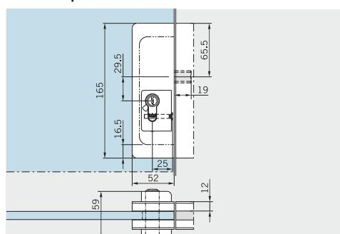
dormakaba Mundus US 20 Comfort cam kapı kilidi, cam kapının orta noktasında kullanılır. Eğer çift kanatlı ise alt resimdeki GK 50 cam kapı kilit karşılığı kullanmak gerekmektedir. Temperli cam ile kullanılır.
